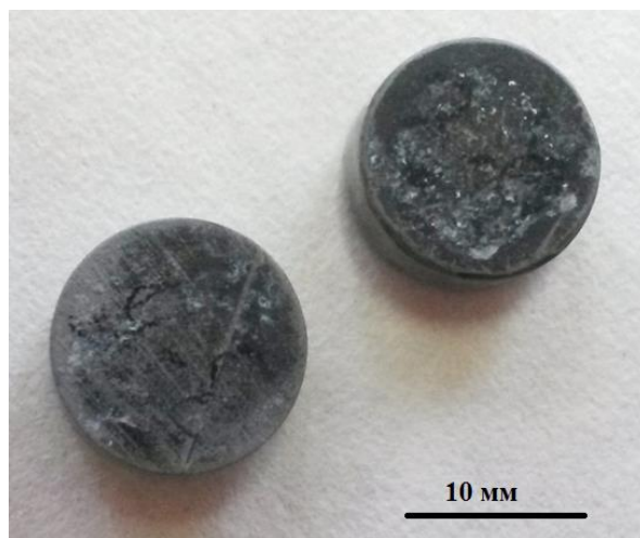
Рис. 5. Внешний вид образцов композита Al-50 % SiC после 480 часов испытаний
