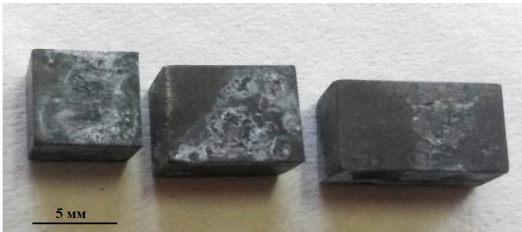
Рис. 1. Внешний вид образцов композита Al-10 % SiC после 480 часов испытаний
