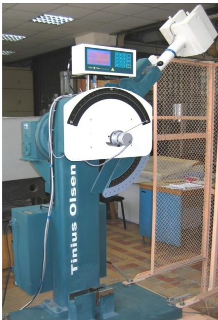
Рис. 3. Определение характеристик ударной вязкости и динамической трещиностойкости
