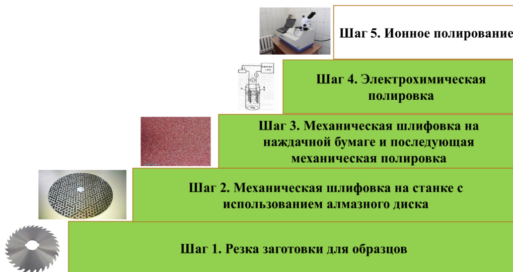
Рис. 6. Схема пробоподготовки ММК для анализа методом ДОРЭ с использованием ионного полирования
