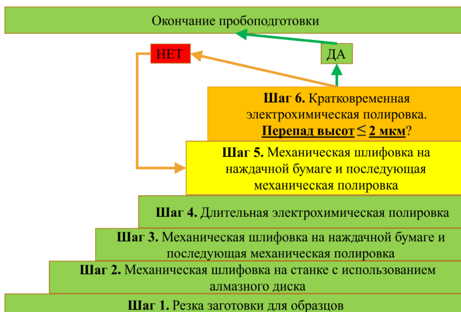
Рис. 8. Итерационная схема пробоподготовки высоконаполненных ММК для анализа методом ДОРЭ
