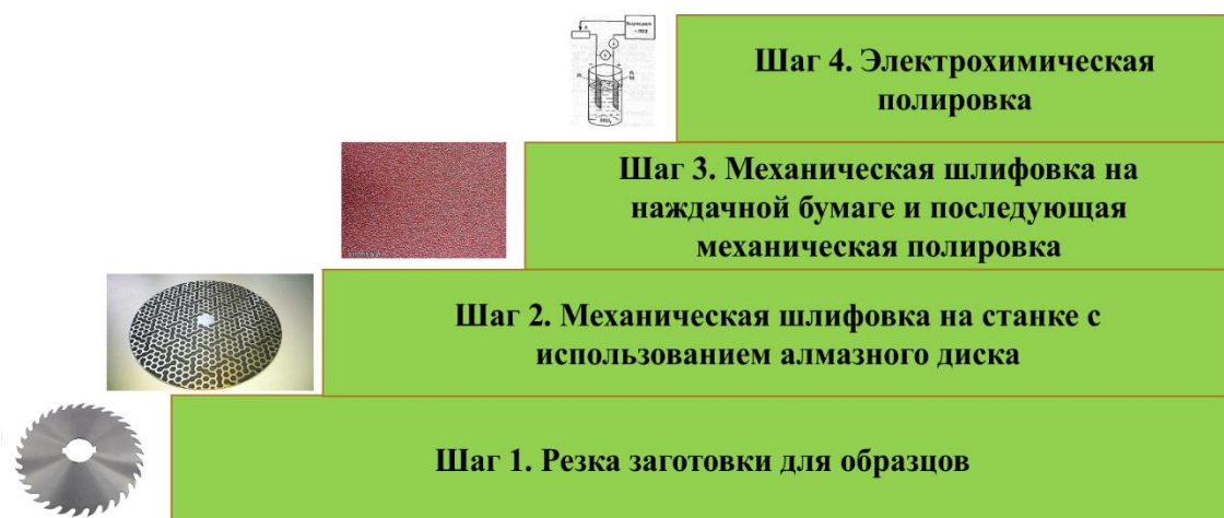
Рис. 3. Схема обработки материалов для ДОРЭ-анализа
