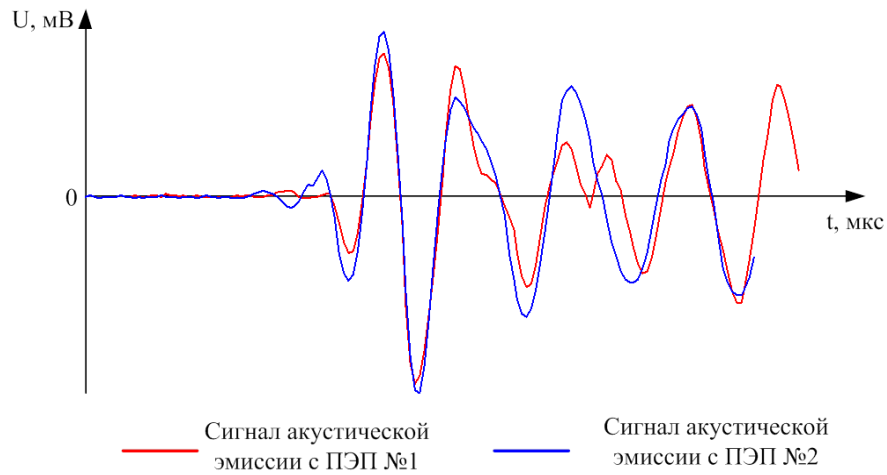
Рис. 9. Сигналы акустической эмиссии со сдвигом во времени \Delta t_1=10\text{мкс}
