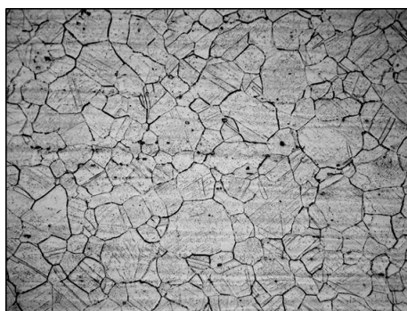
Рис. 3. Микроструктура трубного образца из стали 08Х18Н10Т. Снято на микроскопе «Неофот – 32». Увеличение \times 200
