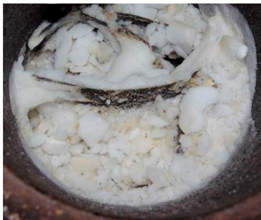
Рис. 1. Гидрат природного газа, полученный в присутствии стальных пластин
