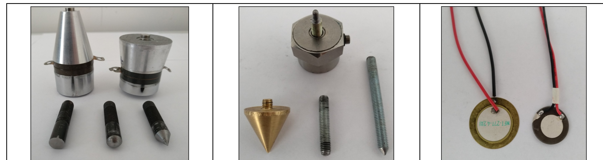
Рис.2. Пьезокерамические преобразователи, используемые для возбуждения акустических волн малой мощности в углепластиковых образцах: сонотроды СШ-4938D-40LAPZT-8, СШ-5938D-28LBPZT-4 (а) и ДН-3(б) с наборами резьбовых шпилек, различающихся площадью контактной поверхности; MFT-27T-4,2A1, P-41 (в).
