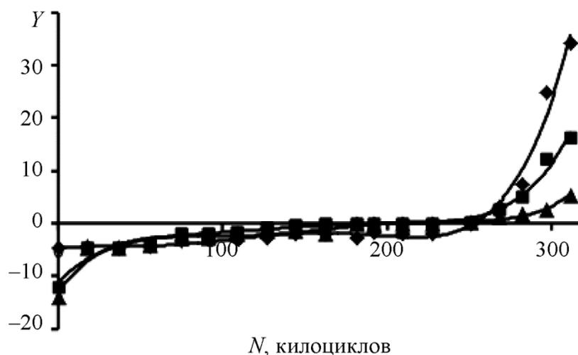
Рис. 3. Зависимость мнимой компоненты  $Y$  безразмерного параметра  $Z$  сигнала вихретокового прибора в трех точках не отожженной (наклепанной) пермаллоевой фольги толщиной 20 мкм от числа циклов  $N$  ее нагружения до разрушения: ■ – точка в центре фольгового элемента; ◆ – точка 2; ▲ – точка 8
