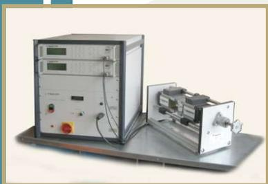
Комплекс предназначен для измерения магнитных характеристик материалов:
