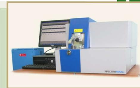
Проведение химического анализа металлов и сплавов на основе железа, меди, алюминия, магния, никеля на макрообразцах.
