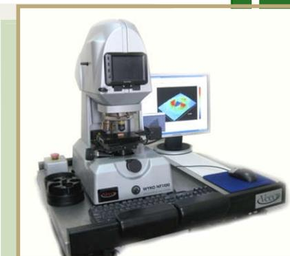
Предназначен для определения топографии поверхности широкого спектра материалов оптическим методом.
