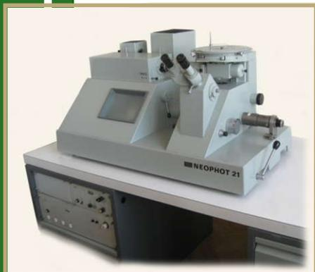
**Предназначен для исследования микроструктуры материалов с фиксированием результатов на фотоснимки.**
