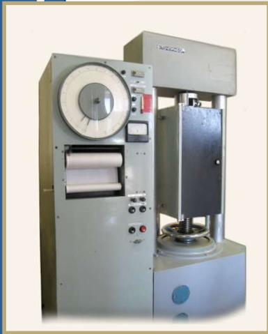
**Испытание образцов из металла на кручение. Машина оснащена измерительной системой СИП-500.**
