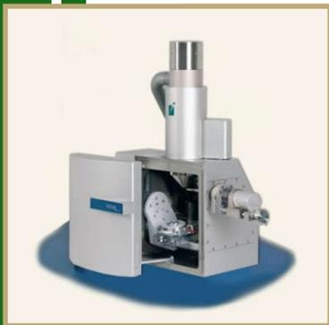
Позволяет исследовать структуру и состояние поверхности с высоким разрешением. Оснащен системой рентгеновских микроанализаторов INCA для исследования структуры, поверхностей разрушения и точного химического микроанализа материалов.
