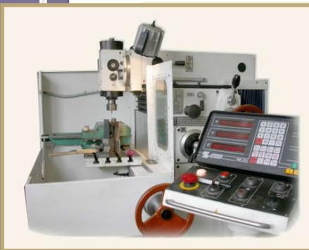
Предназначен для точной и чистовой обработки фрезерованием, растачиванием и сверлением поверхностей образцов массой не более 140 кг.
