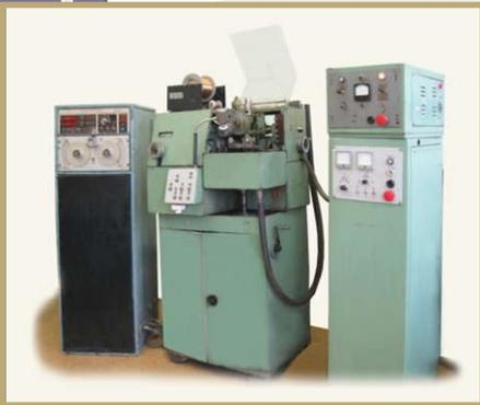
Электроэрозионный вырезной станок с числовым программным управлением модели 4531Ф3 предназначен для обработки деталей сложного контура с прямолинейной образующей. Обрабатываются любые токопроводящие материалы, в том числе и термообработанные стали, металлокерамические сплавы.
