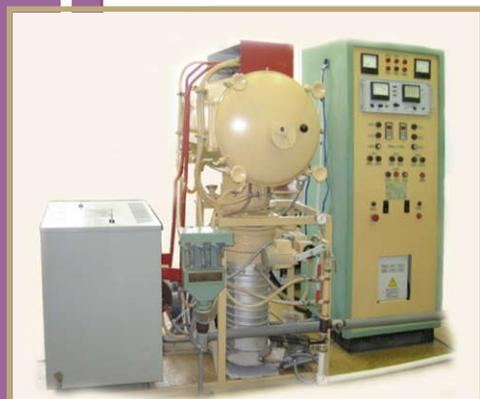
Вакуумная электропечь с металлическими нагревателями и экранной теплоизоляцией для проведения нагрева изделий в вакууме, а также в контролируемой атмосфере инертных газов (аргон, азот) при высокой температуре.
