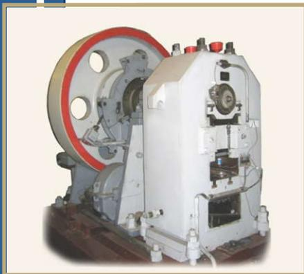
**Используется для изучения сопротивления материалов пластической деформации. Установлена компьютерная система регистрации и обработки экспериментальных данных.**
