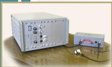
Регистрация и анализ акустических волн, возникающих в процессе деформации и разрушения (роста трещин) контролируемых объектов.
