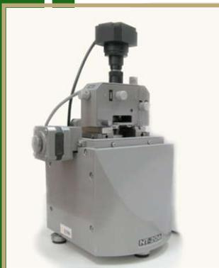
Предназначен для измерения и анализа микро- и субмикрорельефа поверхностей, объектов микро- и нанометрового размерного диапазона, их микромеханических и других свойств с высоким разрешением.
