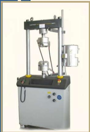
Система предназначена для проведения испытаний на растяжение, сжатие, изгиб, трещиностойкость при статическом и циклическом нагружении (усталостные испытания).
