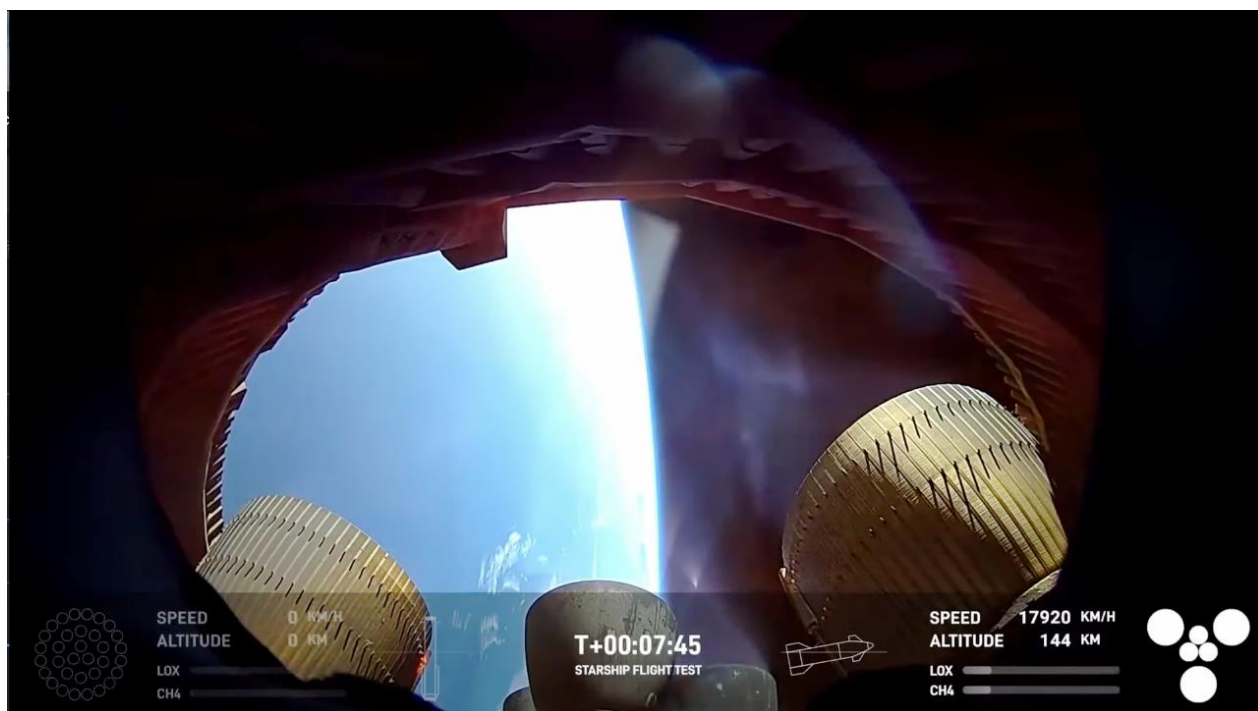
Возможный прогар сопла вакуумного РД Starship S34
