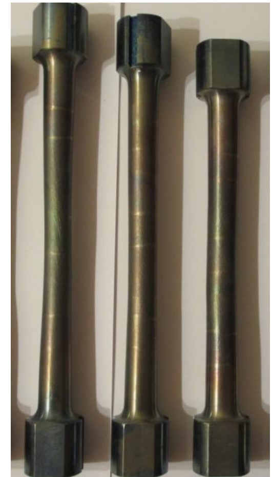
Трубчатые образцы после испытаний при разных отношениях нормального и касательного напряжений
